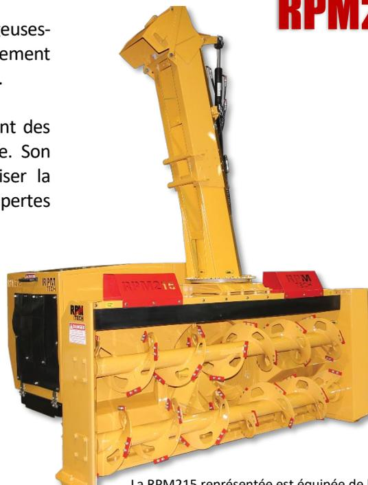
La RPM215 représentée est équipée de brise-glaces boulonnés sur les vis offert en option
