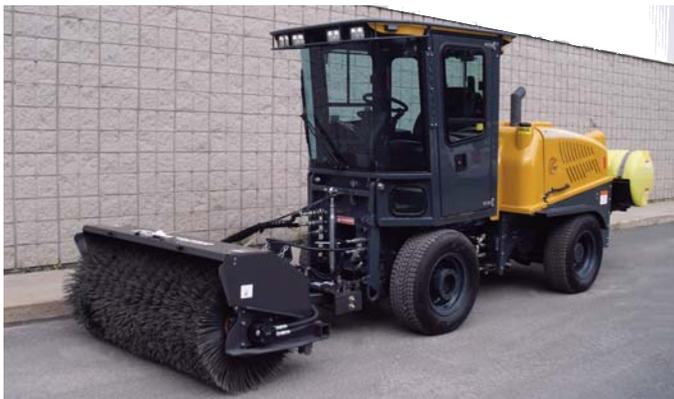
Au printemps, l'unité Caméléon® peut être convertie en un véhicule articulé à 4 roues motrices pour effectuer des applications printanières et estivales telles la tonte de pelouse, le balayage, la tonte des fossés, et ainsi de suite.
