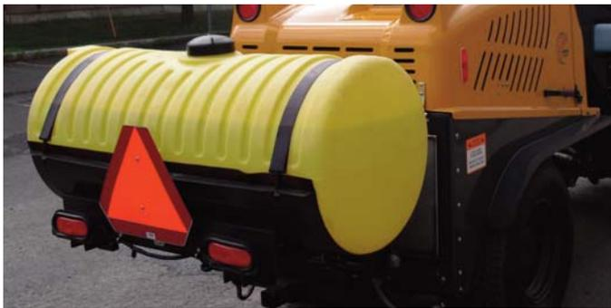
**Un réservoir de fluide antigivrant est offert et les gicleurs sont installés en fonction des besoins du client.**
