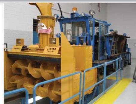
Souffleuse amovible LM220 montée sur une régaleuse à ballast
