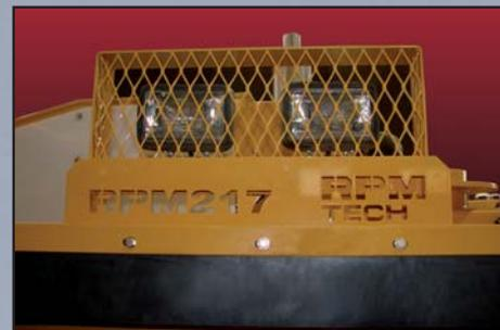
Deux phares de travail optionnels peuvent être installés sur le dessus de la benne afin d'améliorer la visibilité lors des opérations de déneigement sans chargement de la neige dans un camion.
